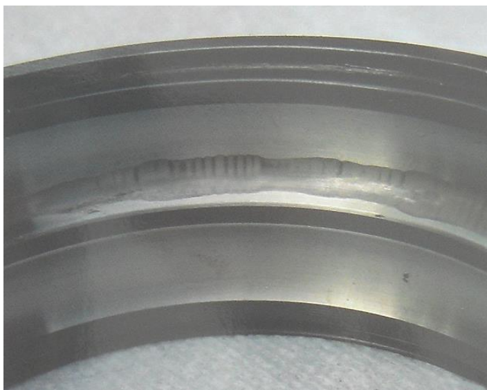
Slika 2: Primer odkrite napake na zunanem obroču ležaja
